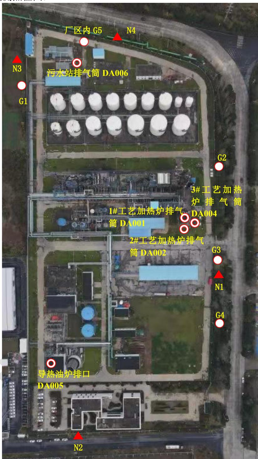
说明: ⊙ 有组织废气监测点, ○ 无组织废气监测点, ▲ 噪声监测点。
